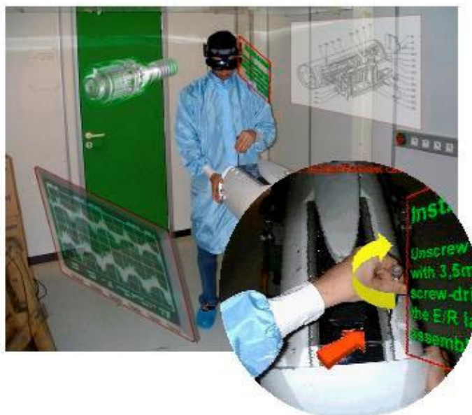
FIGURA 2.9. SISTEMA DE TREINAMENTO PARA A MANUTENÇÃO INDUSTRIAL (SCHWALD, 2003).
