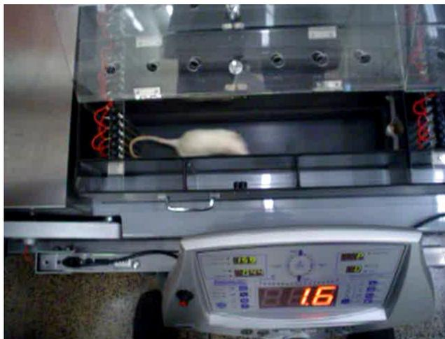
Figura 3. Foto digital da esteira ergométrica para treinamento de corrida para animais de laboratório. (Modelo ERL, Marca New Primer, 110 Volts). Observa-se o painel com marcador digital de velocidade e uma das oito raias existentes com a presença de um animal experimental.
