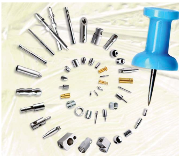
Figura 2: Exemplos de componentes obtidos com microusinagem [14].
