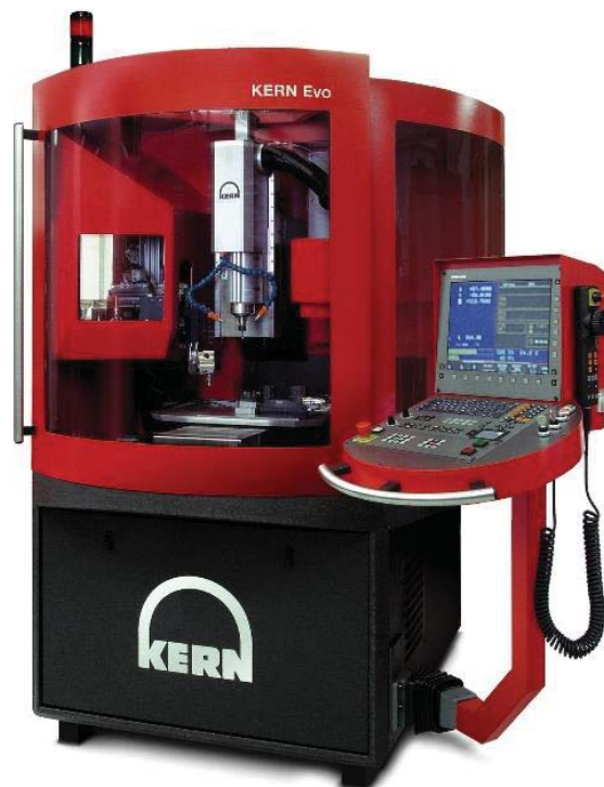
Figura 14: Centro de usinagem de ultraprecisão KERN Evo.
