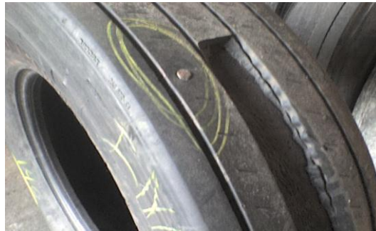
Figura 14: Perfuração e penetração por objeto cortante.
