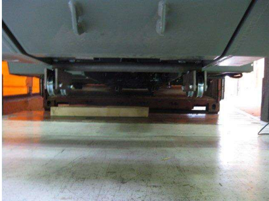
Figura 21 – Polias inferiores no manipulador telescópico, para movimentarem-se sobre os trilhos, no piso do container
