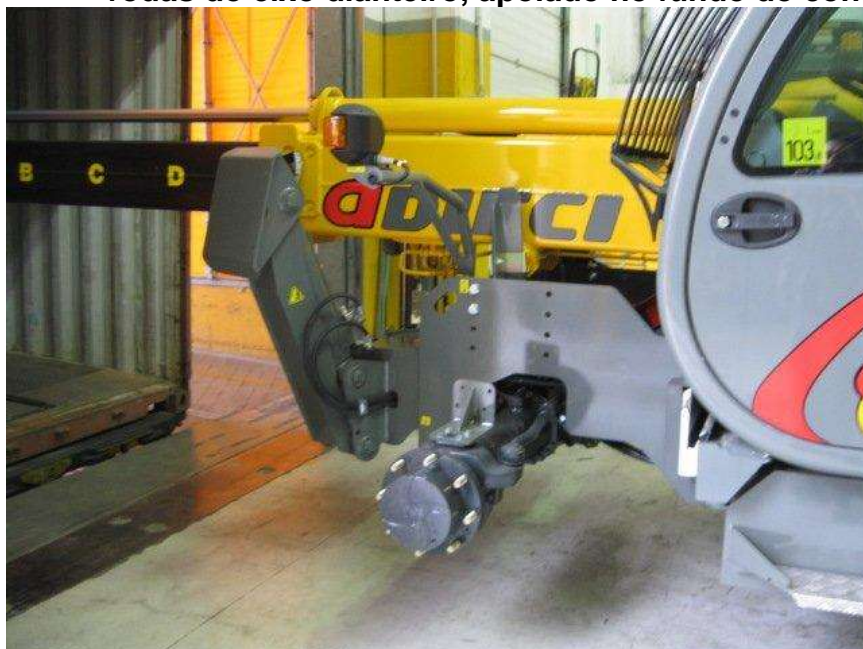
Figura 22 - Manipulador sendo retirado do container, ainda sem as rodas do eixo dianteiro, apoiado no fundo do container
