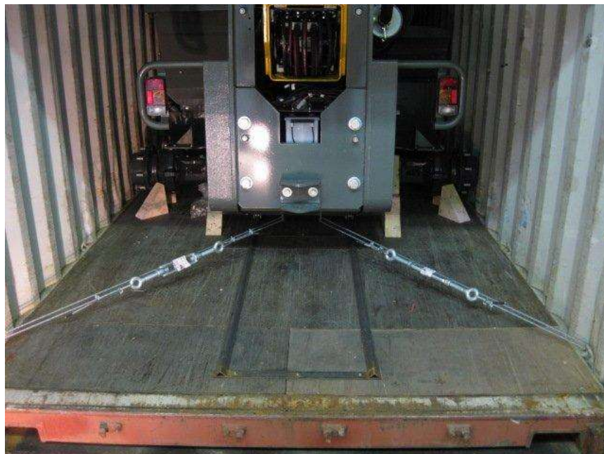
Figura 19 – Manipulador telescópico dentro do container, sem as rodas
