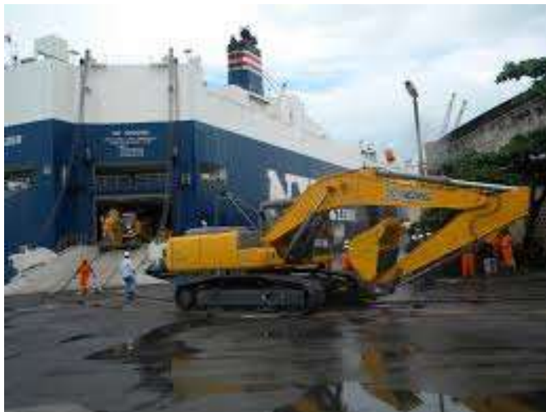
Figura 8 – Navio do tipo ro-ro ( roll-on/roll-off ), descarga de escavadeiras
