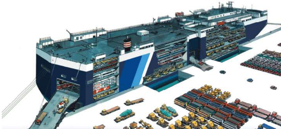
Figura 7 – Desenho esquemático, navio do tipo ro-ro ( roll-on/roll-off )
