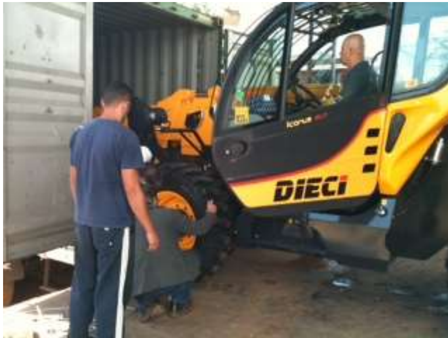
Figura 23 - Manipulador telescópico recebendo as rodas dianteiras, já fora do container
