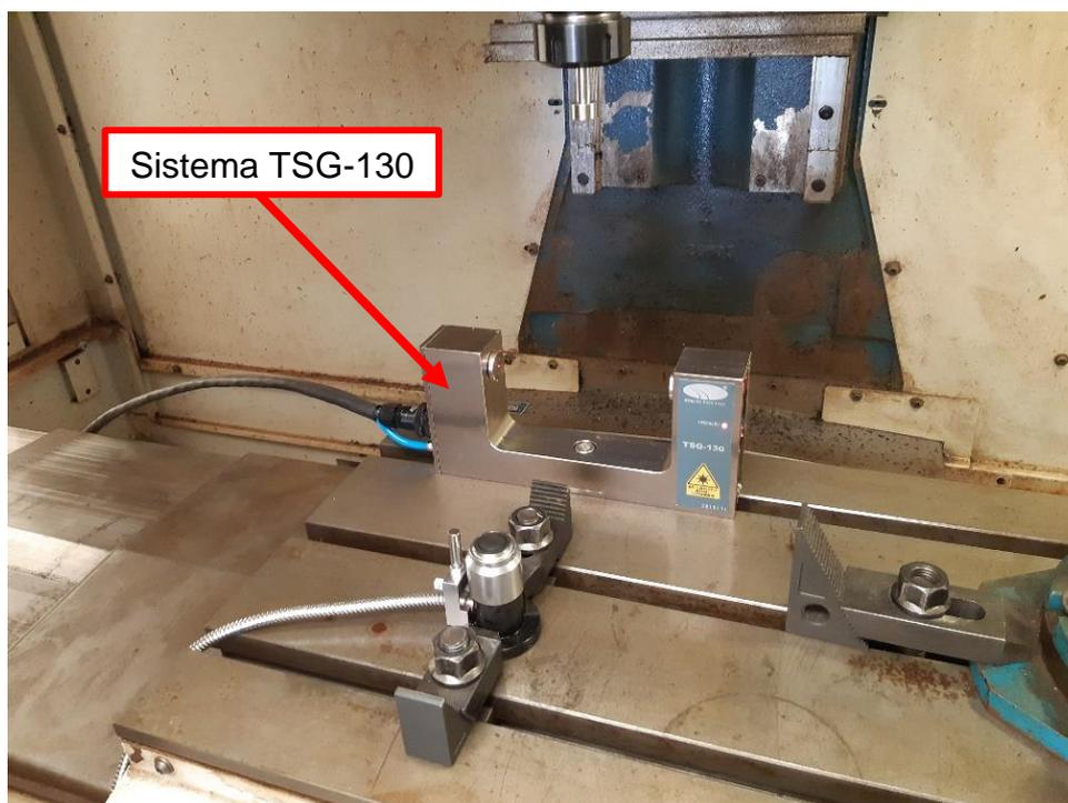
*FIGURA 34 – SISTEMA AUTOMÁTICO DE PRÉ-AJUSTAGEM DE FERRAMENTAS A LASER - TSG-130*
