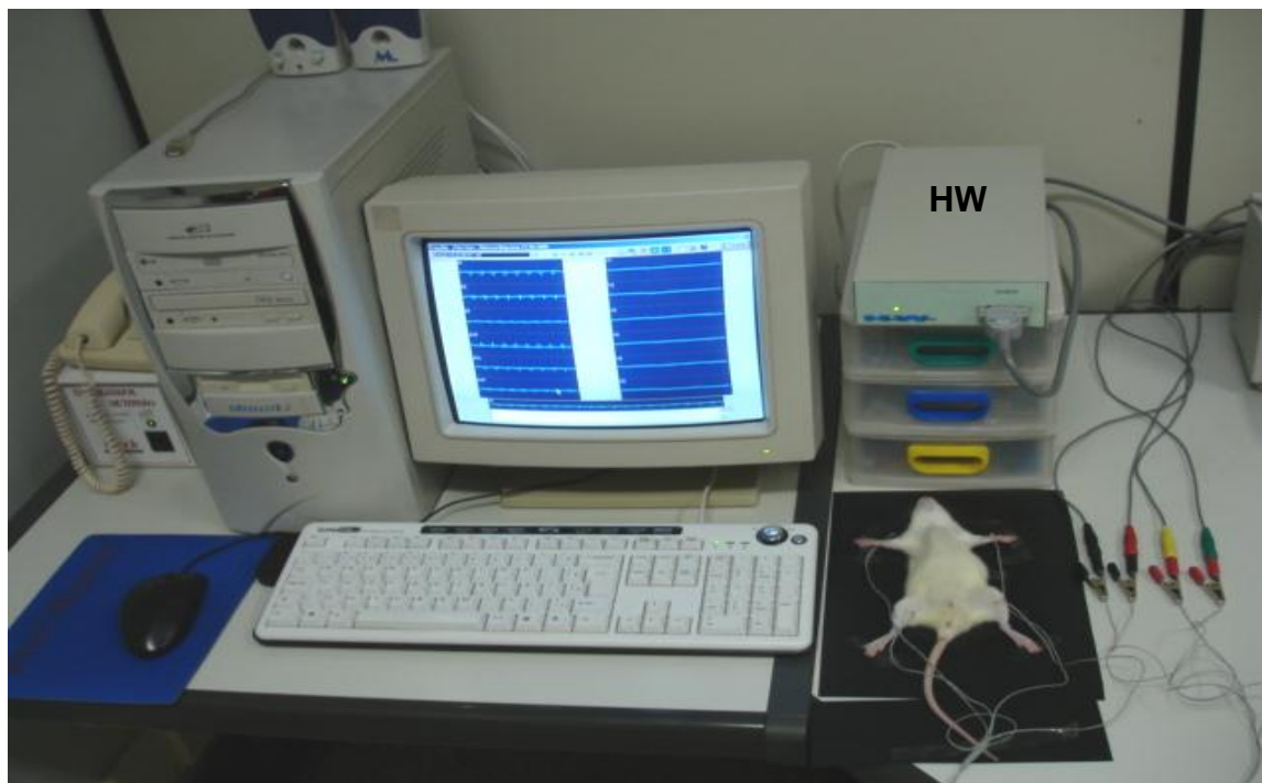
Figura 2. Captação dos sinais eletrocardiográfico através do ECG – Heart Ware 98 (HW).
