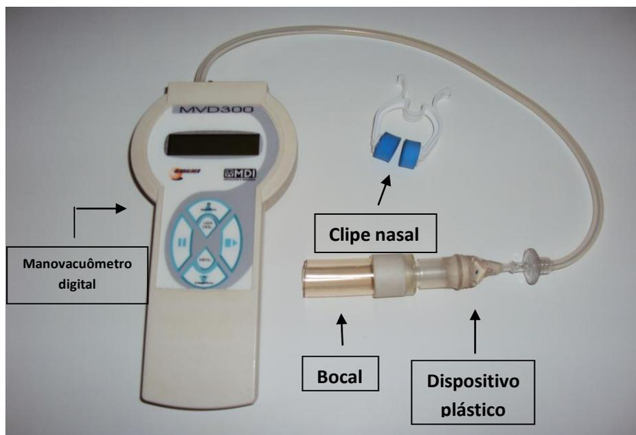
Figura 1. Manovacuômetro digital, dispositivo plástico, bocal e clipe nasal.
