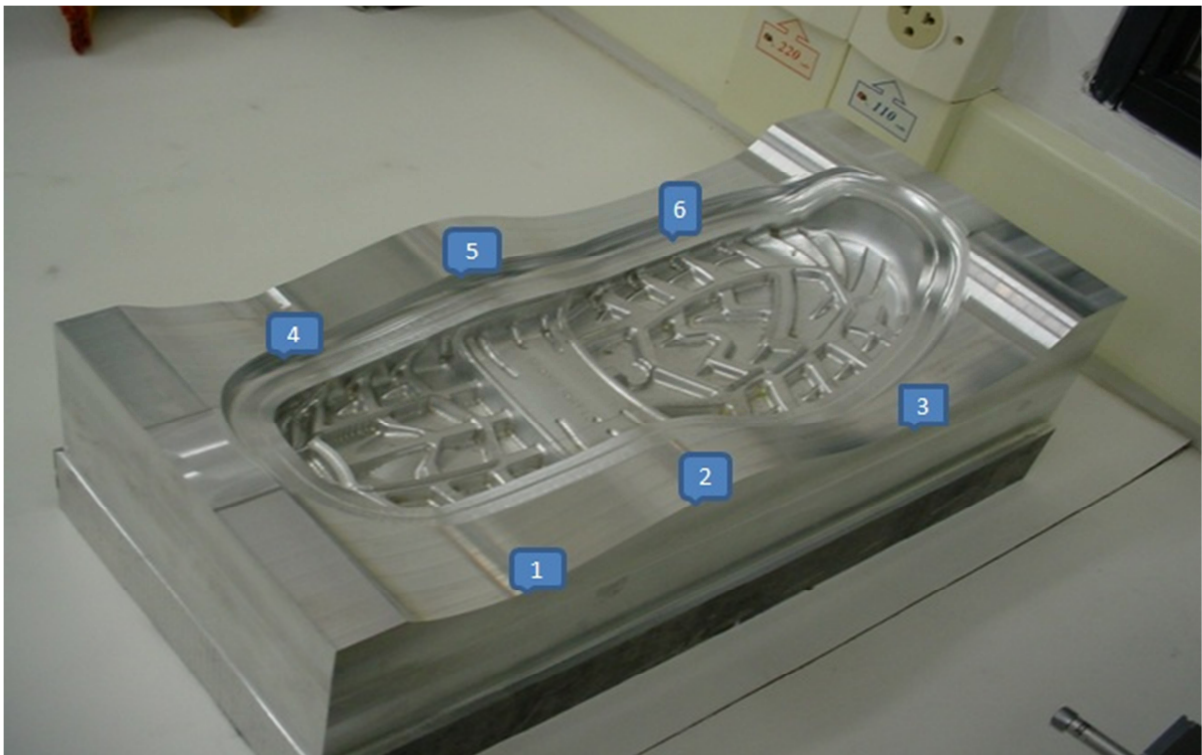
FIGURA 27—REGIÕES UTILIZADAS PARA A MEDIÇÃO DA RUGOSIDADE.
