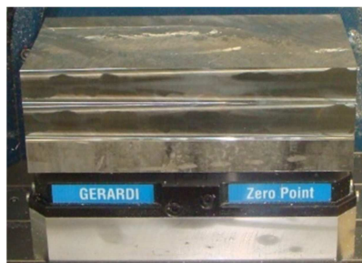
FIGURA 22 - BLANK DE ALUMÍNIO 7075 UTILIZADO NO EXPERIMENTO.
