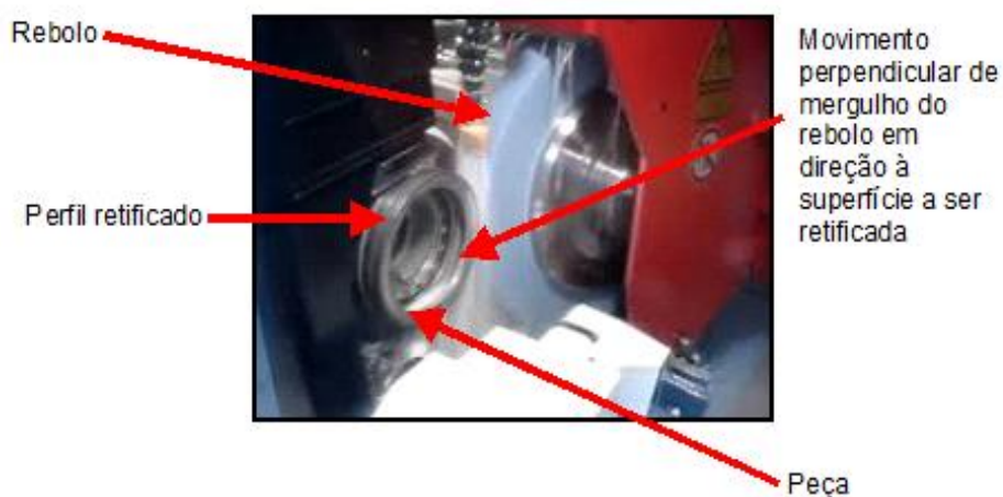
FIGURA 1: PROCESSO DE RETIFICAÇÃO CILÍNDRICA EXTERNA DE MERGULHO.
