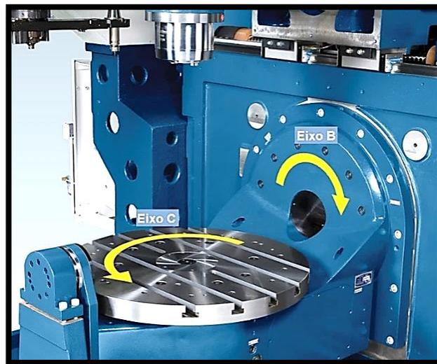
FIGURA 26 – ÂNGULO DE INCLINAÇÃO (B) E ROTAÇÃO (C)
