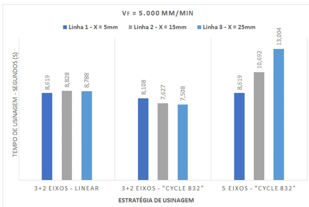
FIGURA 41 - TEMPOS DE USINAGEM - VELOCIDADE DE AVANÇO 5.000 MM/MIN
