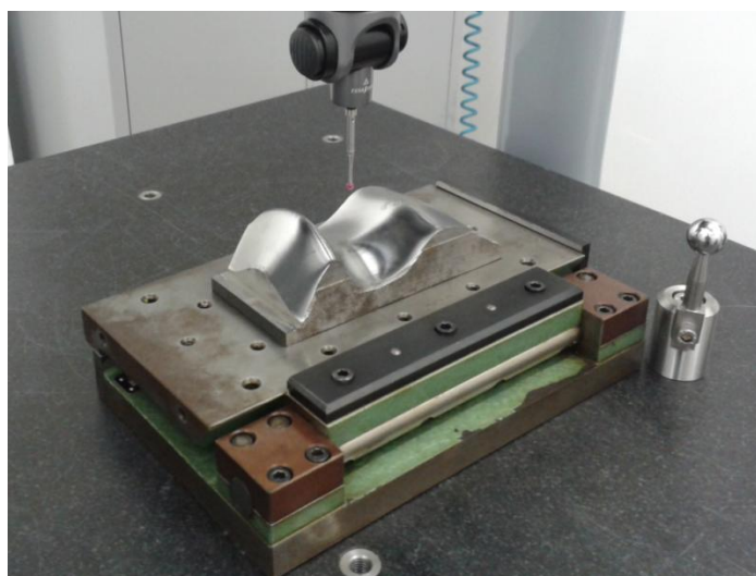
FIGURA 48: SUPERFÍCIE DE FORMA LIVRE AVALIADA COM A MMC.
