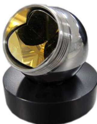
FIGURA 5: RETRO REFLETOR MONTADO ESFERICAMENTE.
