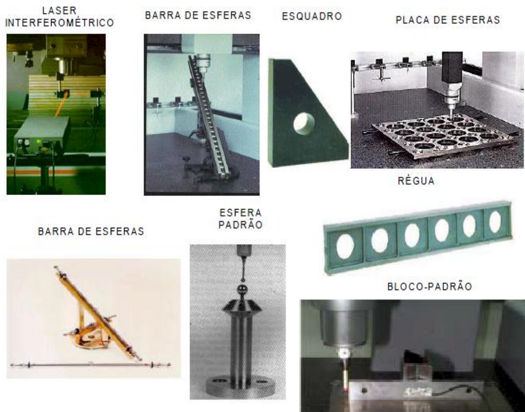
FIGURA 25: PRINCIPAIS PADRÕES UTILIZADOS NA CALIBRAÇÃO.
