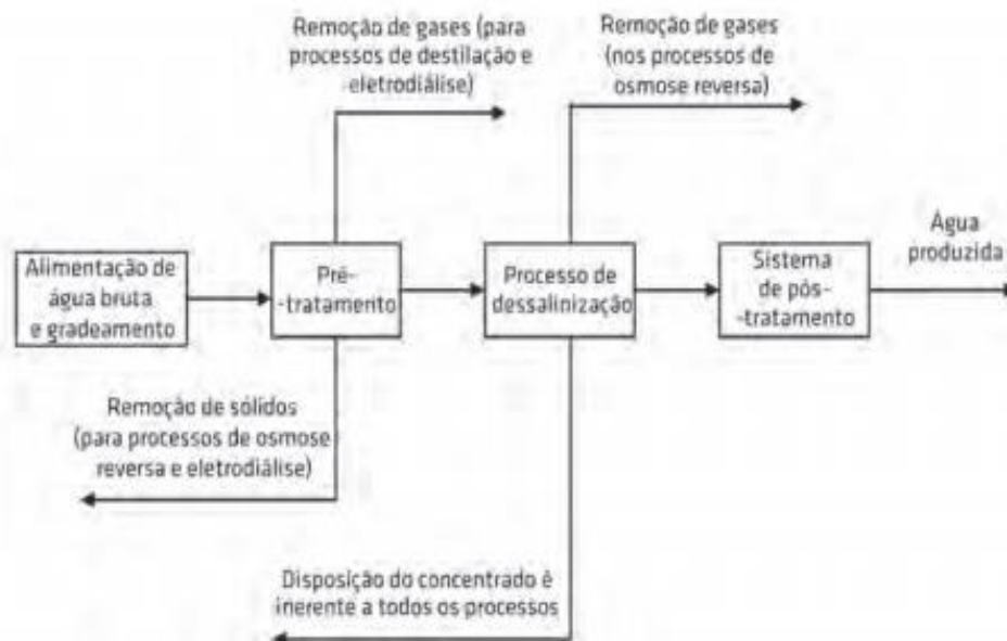
Figura 15: Arranjo geral esquemático da dessalinização para fontes de água bruta superficiais.
