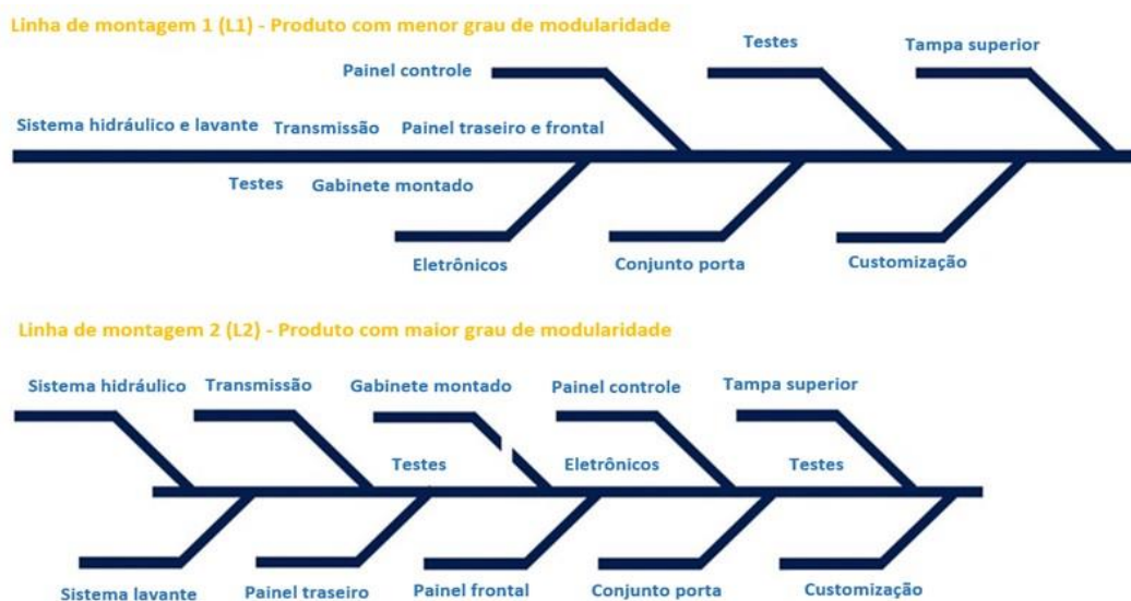
FIGURA 31. ESQUEMA DAS LINHAS DE MONTAGEM PARA PRODUTOS MODULARES.
