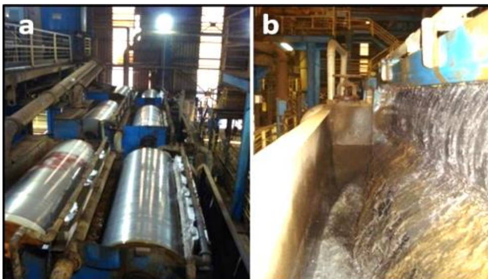
Figura 14: Unidade de concentração: (a) Separadores magnéticos; (b) Saída da Magnetita (Fonte: LEMOS JÚNIOR, 2012).
