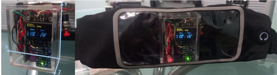
Figura 03. Hardware baseado em tecnologia Arduino para coleta de dados de variação inercial de acelerometria.
