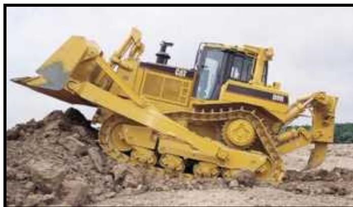
Figura 8 – Trator de Esteiras Com Escarificador. Fonte: Caterpillar® - 2010
