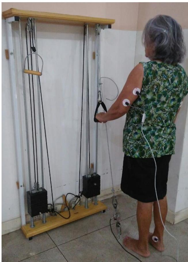
**Figura 5:** Sistema de Roldanas para a coleta do sinal eletromiográfico do músculo tríceps braquial.
