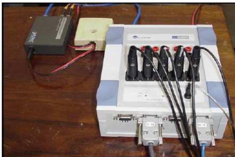
Figura 2 - Módulo de Aquisição de Sinais (MAS) modelo EMG 1000 da Lynx® com quinze condicionadores de sinais, sendo seis passivos, cinco ativos e quatro para instrumentação.
