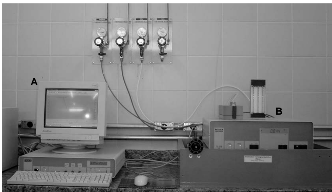
Figura 2 – Equipamento para análise termogravimétrica. (A) Microcomputador e (B) Analisador termogravimétrico.
