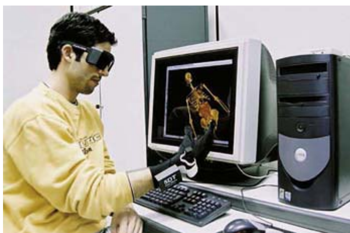
Figura 6. Sistema de Projeção em Estação de Trabalho, luva e óculos estereoscópicos (Laboratório de RV – UNIMEP, 2006).
