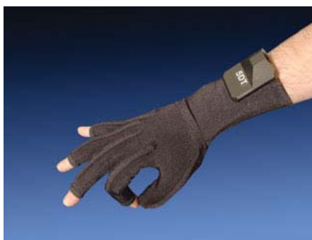
Figura 2. Exemplo de luvas utilizadas em sistemas de RV (Fifth Dimension Technologies, 2005).
