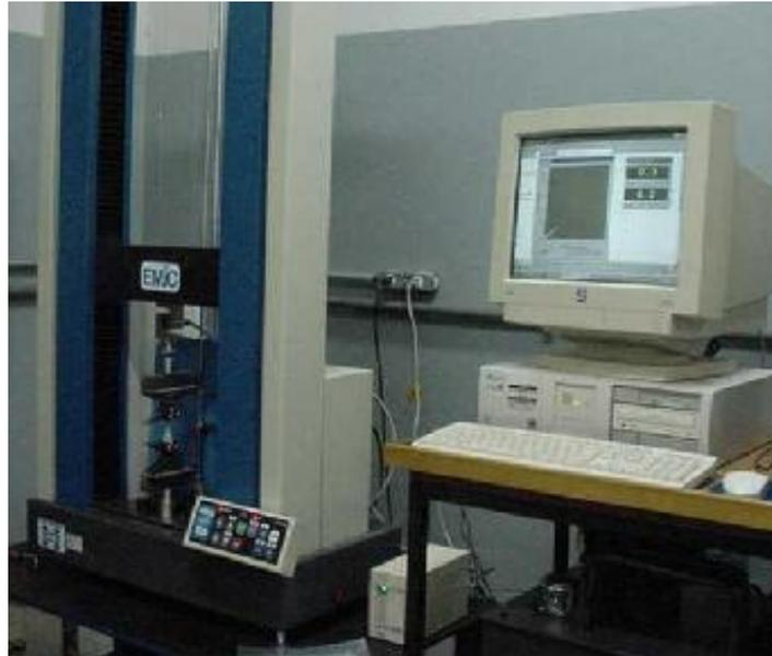
**Figura 03** – Máquina Universal de Ensaio Mecânico, DL 2000 Emic®, conectado ao microcomputador com o programa de coleta de dados Tec. Versão 1. 1 – Laboratório de Materiais de Construção Mecânica da UNIMEP – Santa Bárbara do Oeste – SP.
