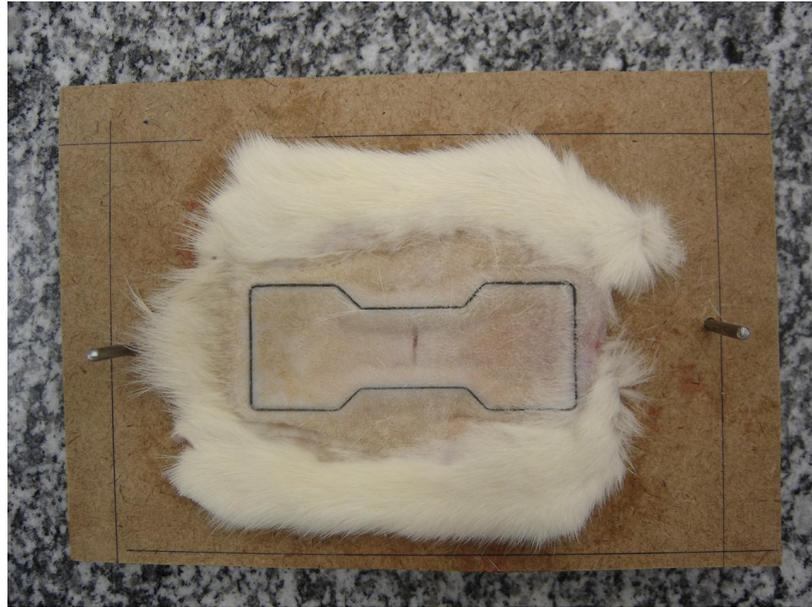
**Figura 06** – Forma de corte para a padronização das amostras (corpo de prova).
