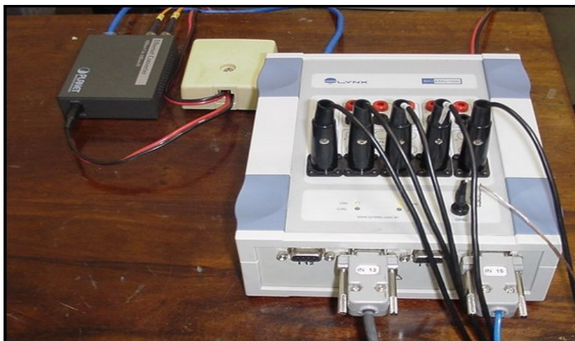
Figura 2- Módulo de Aquisição de Sinais (MAS) modelo EMG 1000 da Lynx®. Quinze condicionadores de sinais, sendo 6 passivos, 5 ativos e 4 para instrumentação.
