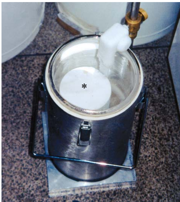
Figura 6 - Recipiente com isopentano (*) resfriado em nitrogênio líquido.
