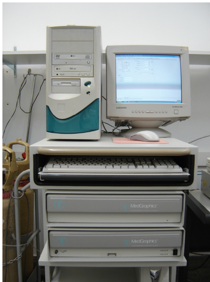
Figura 2. Ilustração do espirômetro (Med-Graphics – Breeze 6.0)
