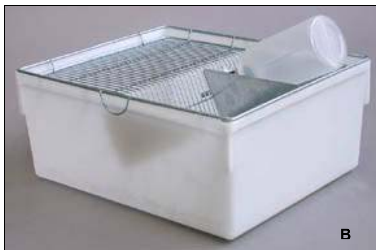
Figura 3: Caixa de polietileno pequena padrão (A), com dimensões de 17X13X28 cm e caixa de polietileno grande padrão (B), de 30X13X44 cm. Ambas apresentam dispositivos de comida e água fixos.
