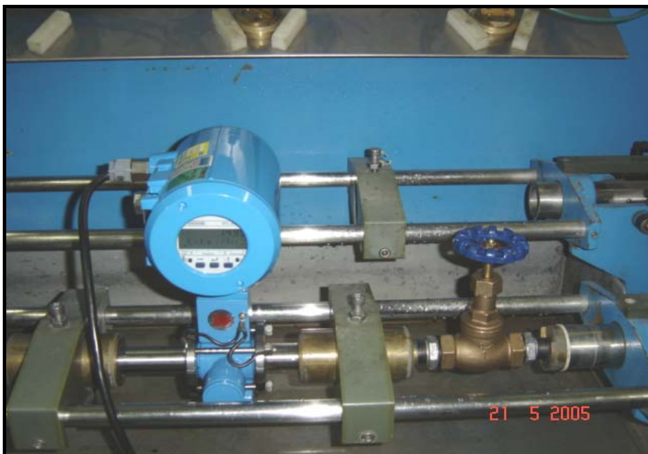
Figura 17 – Válvula tipo agulha utilizada para ajuste fino da vazão.
