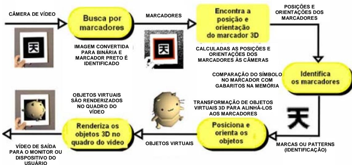
Figura 7 - Diagrama descritivo dos passos da detecção dos marcadores e o posicionamento dos objetos virtuais sobre os marcadores detectados na cena do mundo virtual
