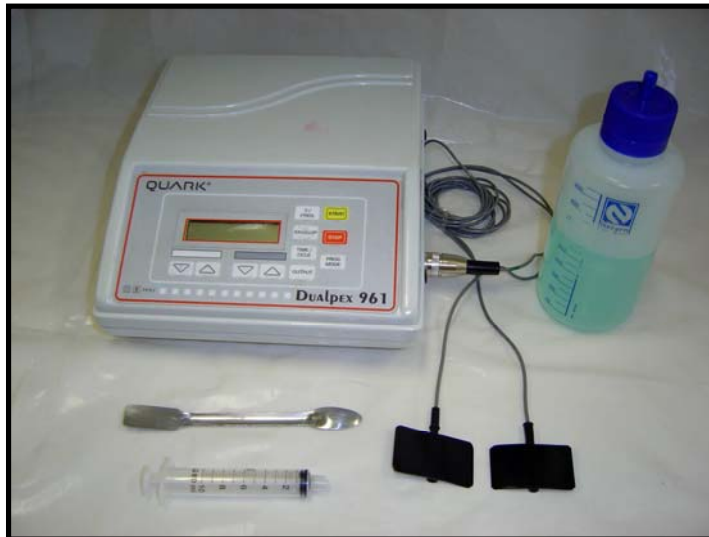
Figura 6– Material para coleta de dados formado por Aparelho Dualpex 961® (Quark), com cabo de saída para dois eletrodos de silicone-carbono, gel hidrossolúvel, seringa para medição e espátula.
