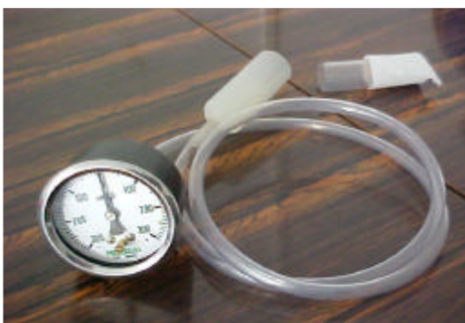
Figura 1.A. Manovacuômetro analógico com o respectivo circuito, adaptador e bocal; Figura 1.B. Realização do teste de manovuometria.
