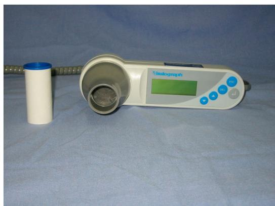
Figura 1- Espirômetro Vitalograph 2120
