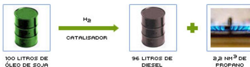
**FIGURA 3.7- VOLUME DE OBTENÇÃO DO PROCESSO DO H-BIO**
