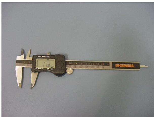
**Figura 5** – Paquímetro digital Digimess<sup>®</sup>
