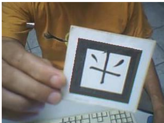
Figura 13. Exemplo de marcador de RA de 80x80 (milímetros)
