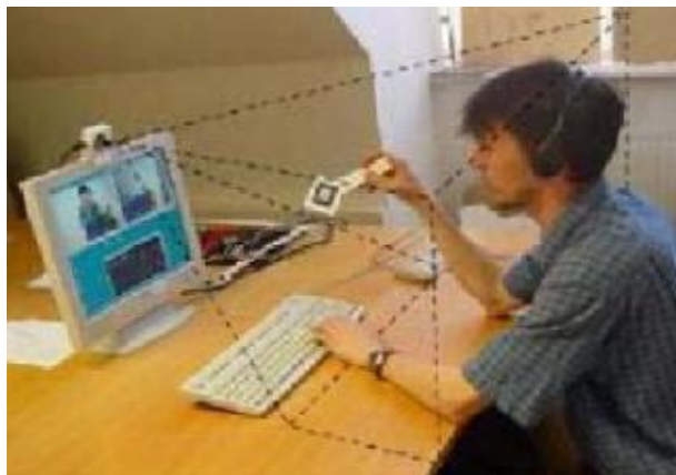
Figura 9. Sistema de RA baseado em monitor (BARAKONYI, 2003)
