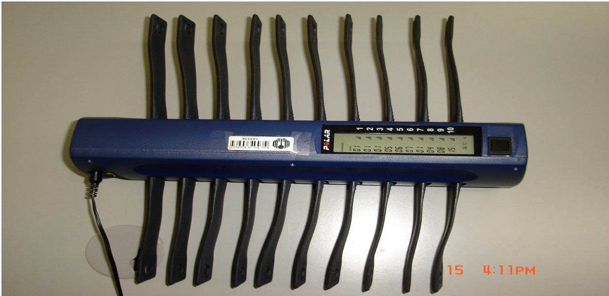
Figura 3: Foto da Unidade Interface ® utilizada para transferência dos dados da fita transmissora para o computador.
