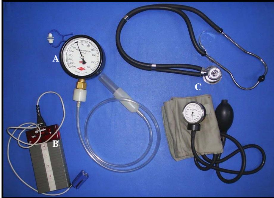
Figura 04: Alguns equipamentos utilizados para a realização deste estudo A: Manovacuômetro marca Ger-Ar; B: Oxímetro de Pulso NONIN®; C: Esfigmomanômetro e estetoscópio.
