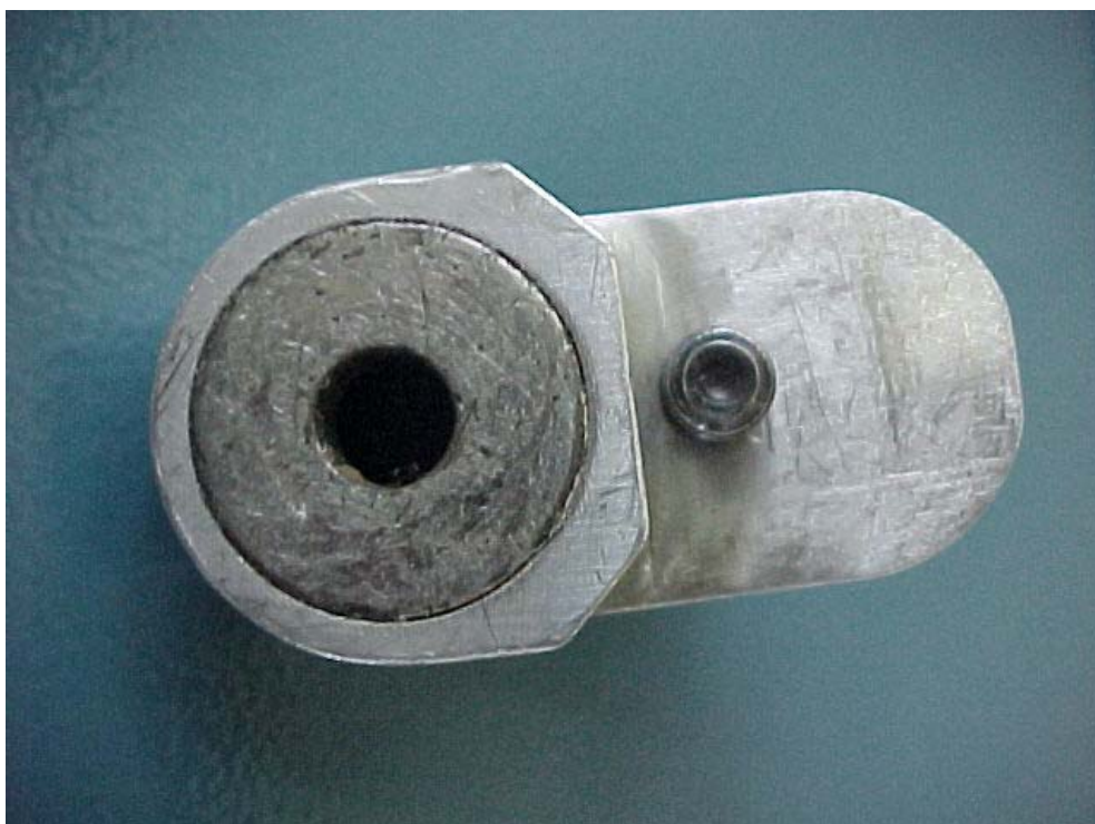
FIGURA 34 - VISTA DO FIXADOR MAGNÉTICO COM DESTAQUE PARA O IMÃ TERRA
