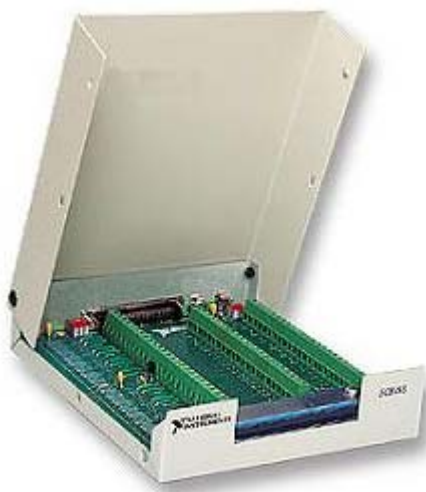
FIGURA 30 - CONECTOR DE BLOCOS SCB-68
