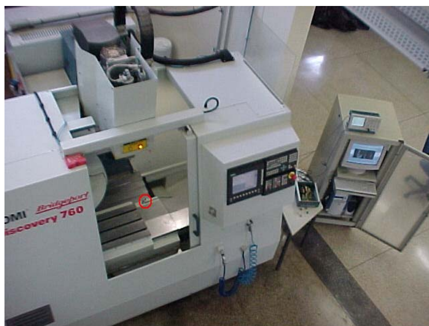
FIGURA 26 - POSIÇÃO UTILIZADA PARA TESTES COM O SENSOR DE EA (AVENTAL DA MESA PORTA-PEÇA)
