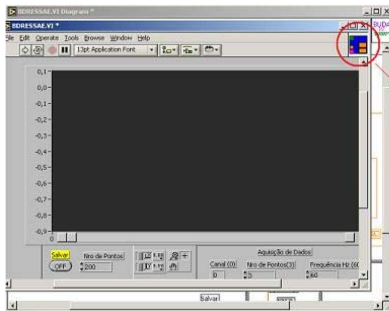
FIGURA 17 - PAINEL DE CONECTORES DE UM SUBVI (CADA COR CORRESPONDE À UM TERMINAL DIFERENTE).
