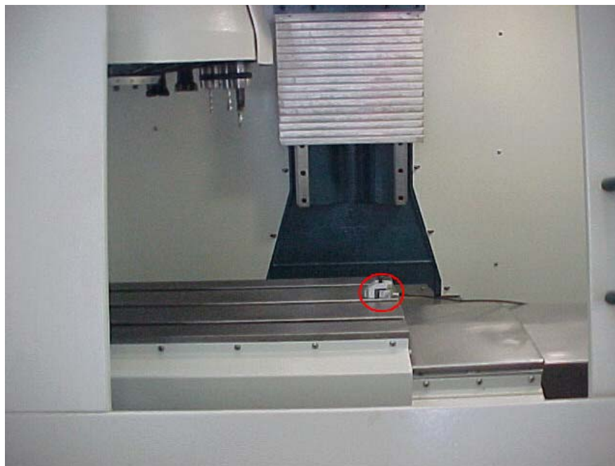
FIGURA 25 - POSIÇÃO UTILIZADA PARA TESTES COM O SENSOR DE EA (MESA PORTA-PEÇA)
