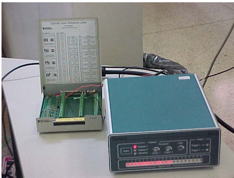
FIGURA 28 - SENSIS BM-12 LIGADO AO CONECTOR DE BLOCO SCB-68
