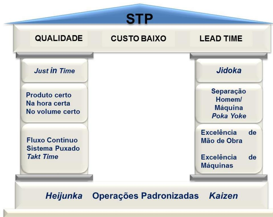
**FIGURA 10:** Estrutura do Sistema *Toyota* de Produção ( Adaptado de GHINATO 2000)
