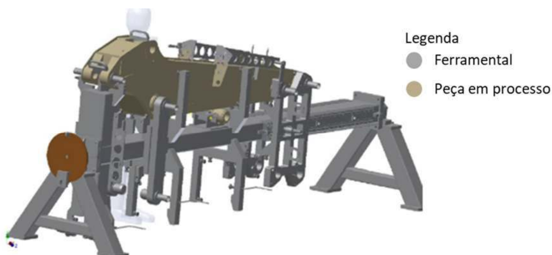
FIGURA 1 – FERRAMENTAL PARA MONTAGEM E PONTEAMENTO DE PEÇA
