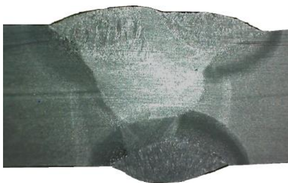
FIGURA 37-MACROGRAFIA DA JUNTA SOLDADA CP2-SMAW
