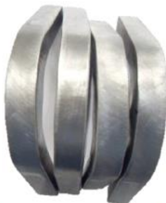
FIGURA 29-CORPOS DE PROVA SOLDADOS APÓS ENSAIO DE DOBRAMENTO.
