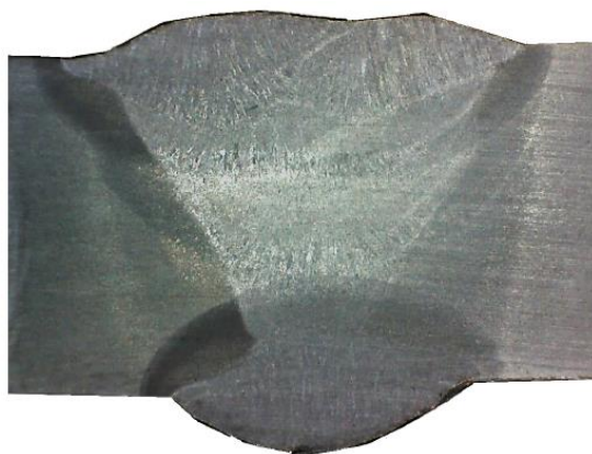
FIGURA 36-MACROGRAFIA DA JUNTA SOLDADA CP1-GMAW
