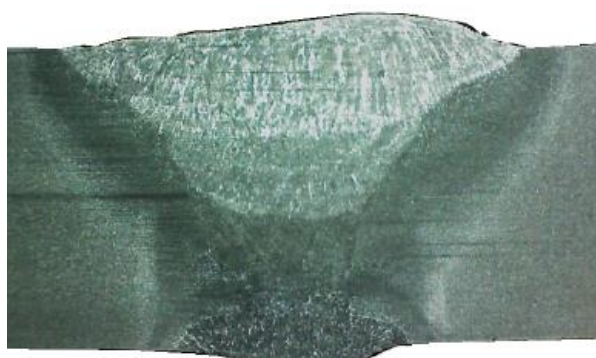
FIGURA 38-MACROGRAFIA DA JUNTA SOLDADA CP3-FCAW
