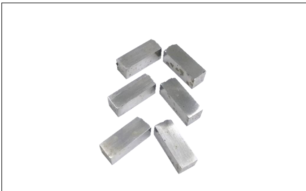
FIGURA 30 - CORPOS DE PROVA APÓS ENSAIO DE IMPACTO CHARPY
