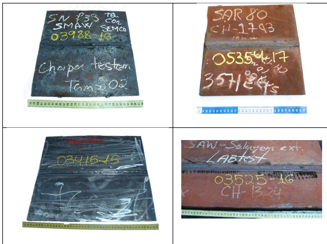
FIGURA 20-CORPOS DE PROVA APÓS SOLDAGEM (PRÓPRIO AUTOR)
