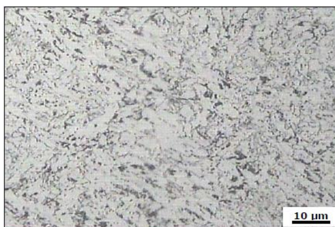
FIGURA 34-MICROGRAFIA DO METAL DE SOLDA DO CP3
