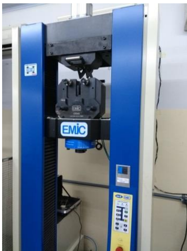
FIGURA 16-EQUIPAMENTO UNIVERSAL DE ENSAIO (PRÓPRIO AUTOR)
