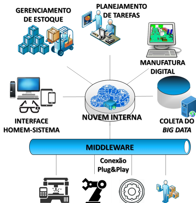
Figura 3: Exemplo de arquitetura de um CPPS, adaptado de Cao et al. [32]
