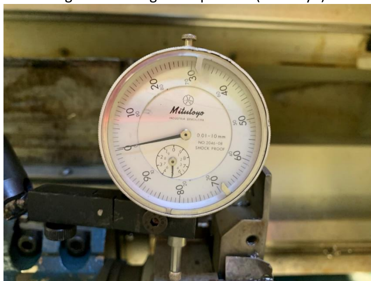
Figura 6 – Relógio comparador (Mitutoyo)
