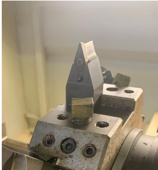
Figura 12 – Pastilha metal duro para acabamento (Sandvik)
