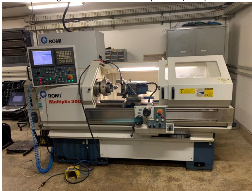
Figura 4 – Torno CNC Multiplic 30D (Romi)
