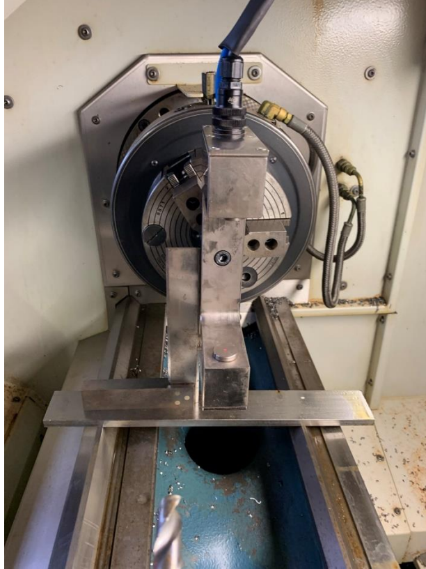
Figura 18: Fixação do toolsetter na placa do torno para medição de ferramentas
