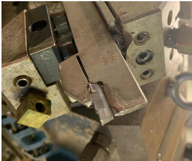
Figura 10 – Pastilha bedame para cortes e sulcos (Korloy)
