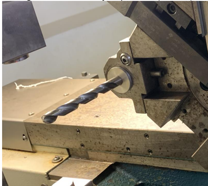
Figura 9 – Broca de aço rápido HSS (Dormer)
