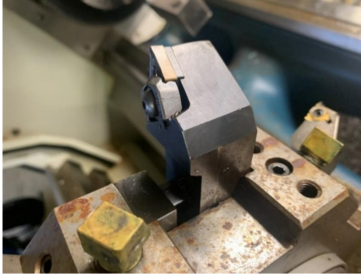
Figura 11 – Pastilha metal duro para desbaste (Iscar)
