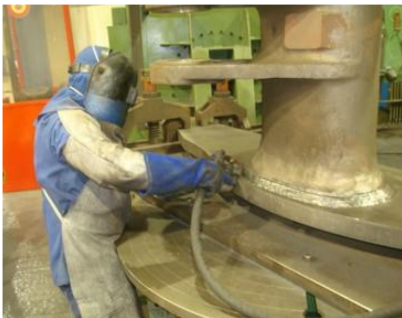
FIGURA 13 - ACESSO E VISIBILIDADE DO SOLDADOR DURANTE A SOLDAGEM MANUAL
