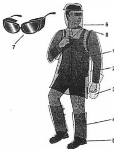
FIGURA 4 - VESTUÁRIO DE PROTEÇÃO TÍPICO A SER USADO POR UM SOLDADOR: (A) AVENTAL DE COURO; (B) MANGA DE COURO; (C) LUVA DE COURO; (D) PERNEIRAS DE COURO; (E) SAPATOS DE SEGURANÇA; (F) CAPACETE DE PROTEÇÃO; (G) ÓCULOS DE SEGURANÇA; (H) OMBREIRA DE COURO.
