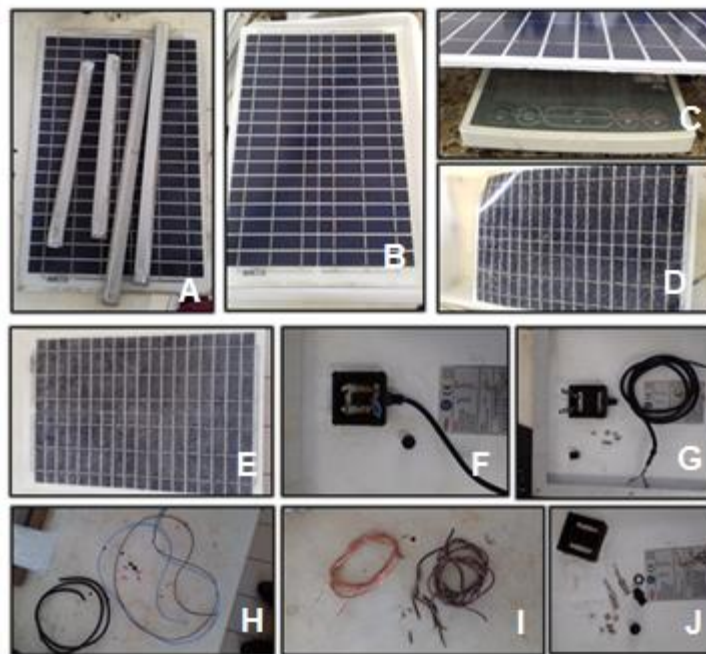
Figura 24: Etapas do processo de desmontagem do módulo FV 1.
