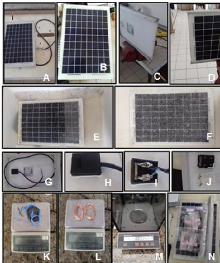
Figura 25: Etapas do processo de desmontagem do módulo FV 2.
