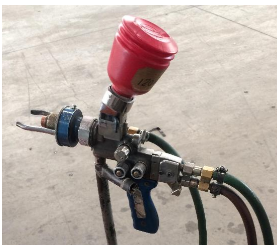
FIGURA 19 – PISTOLA DE ASPERSÃO FLAME SPRAY COM MATERIAL EM PÓ
