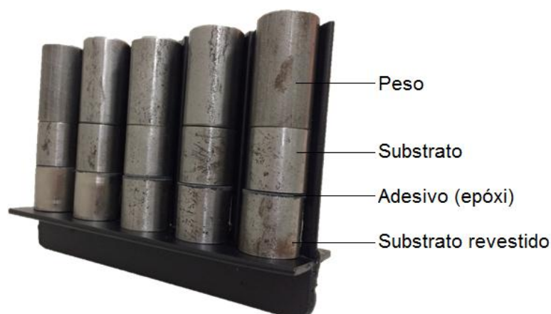
FIGURA 27 – ESQUEMA DA PREPARAÇÃO DO CORPO DE PROVA DE TRAÇÃO
