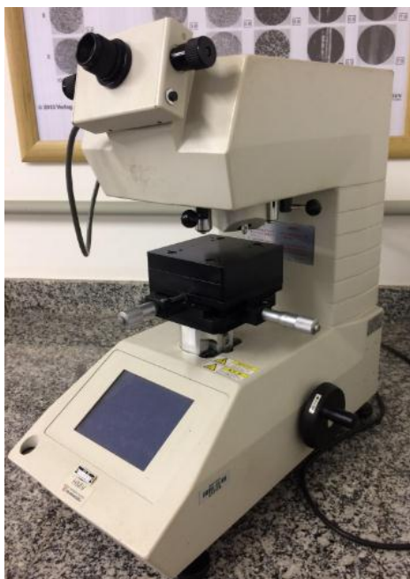
FIGURA 23 – MICRODURÔMETRO SHIMADZU UTILIZADO PARA MEDIÇÃO DE MICRODUREZA DOS REVESTIMENTOS
