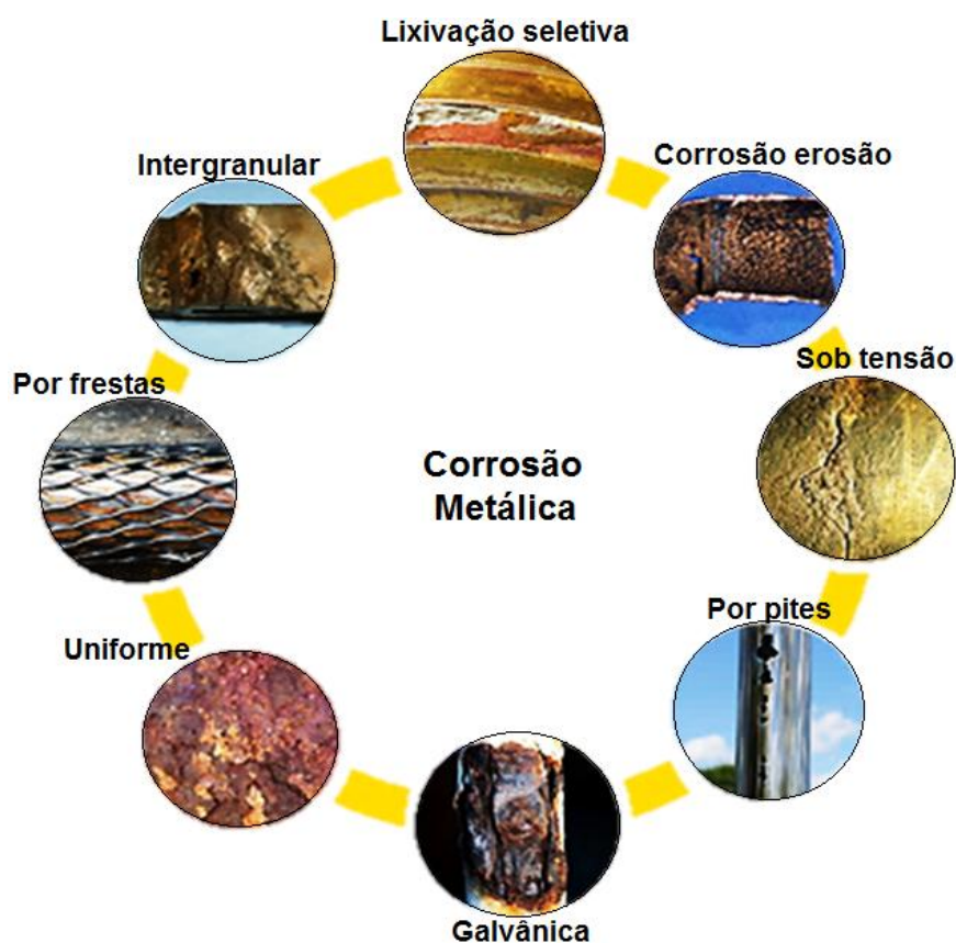
FIGURA 3 – PRINCIPAIS FORMAS DA CORROSÃO METÁLICA
