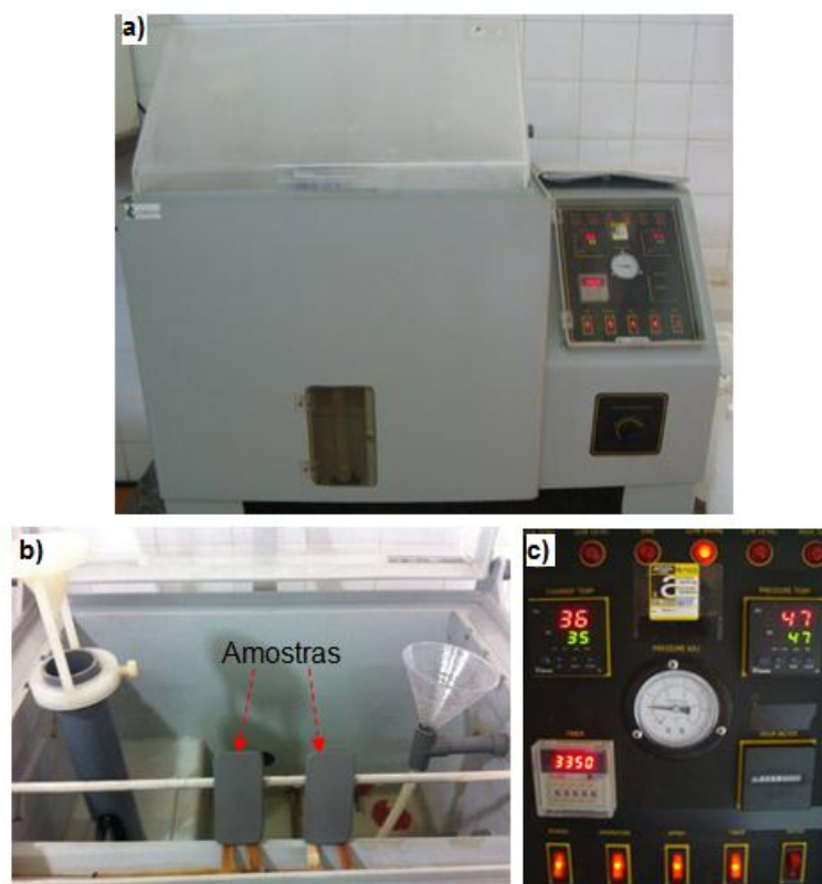
FIGURA 29 – EQUIPAMENTO DE ENSAIO SALT SPRAY: (A) CÂMARA DE NÉVOA SALINA; (B) AMOSTRAS POSICIONADAS NA PARTE INTERNA DA CÂMARA; (C) VISOR PARA AJUSTE DOS PARÂMETROS DO ENSAIO
