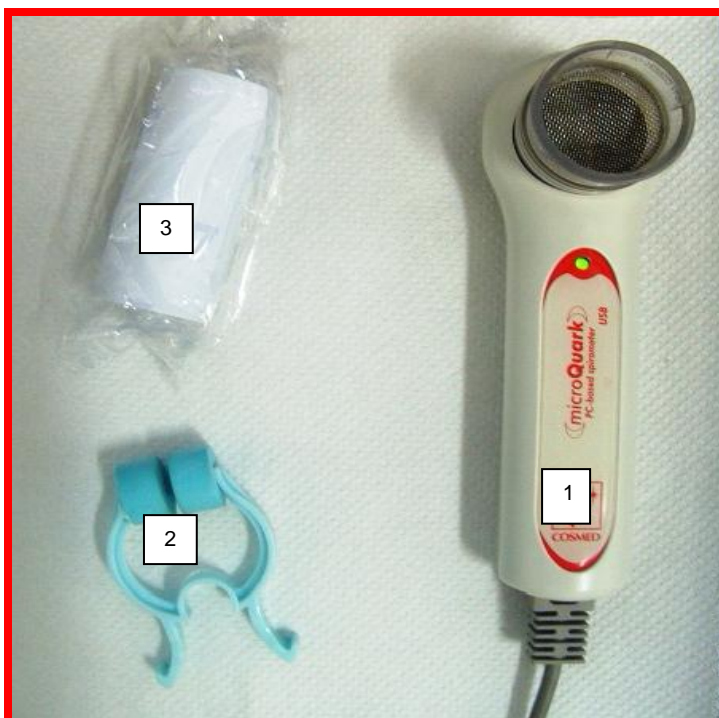
Figura 1- Espirômetro computadorizado ultra-sônico com sensor de fluxo, modelo Microquark, marca Cosmed, Roma Italia (1), clipe nasal (2) e bocal descartável (3).
