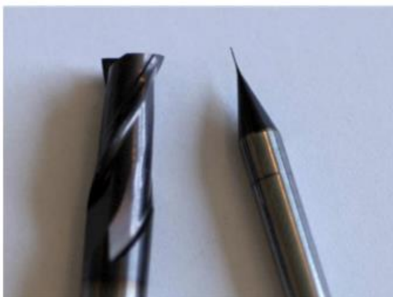
Figura 2.4: Fresa de topo reto de 6 mm de diâmetro (à esquerda) e micro-fresa de 200 \mu\text{m} (à direita) [2]
