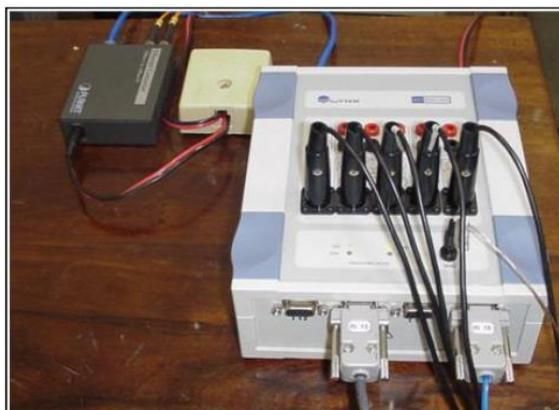
**Figura 4** – Módulo de aquisição de sinais EMG 1000 (Lynx<sup>®</sup>)
