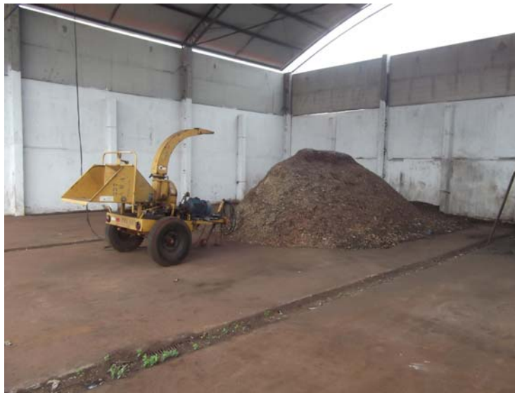
Figura 58 - Picador e monturo de cavacos fonte de carbono da usina, CTR, Londrina-PR, 2012
