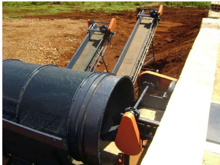
Figura 16 - Usina de triagem detalhe esteiras, CTR, Londrina, 2010
