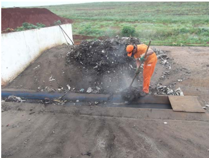
Figura 64 - Funcionário abastecendo a esteira de alimentação da usina de compostagem, CTR, Londrina-PR, 2012
