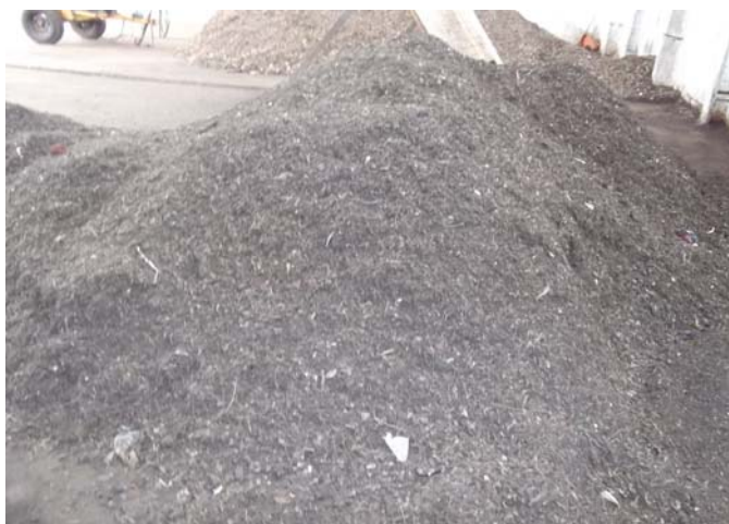
Figura 65 - Leira com presença de restos de sacos plásticos, CTR, Londrina-PR, 2012
