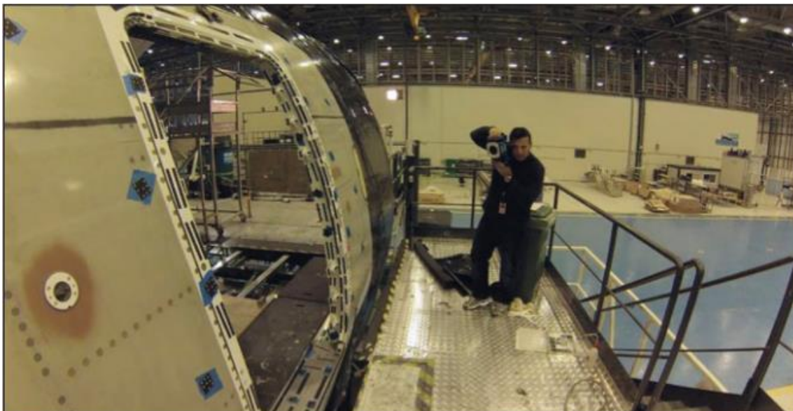
FIGURA 17 : INSPEÇÃO POR FOTOGRAMETRIA DE UMA PORTA EM UMA AERONAVE BOEING 787 (LAZAR., 2015)
