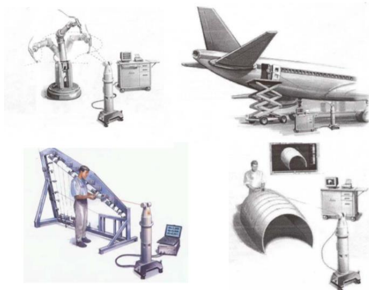
FIGURA 6 : EXEMPLO DE APLICAÇÕES DE LASER TRACKERS FONTE: CATÁLOGO LEICA LASER TRACKER - PORTABLE COORDINATE MEASURING MACHINE.
