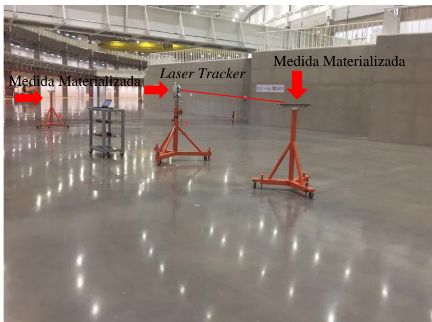
FIGURA 49 : ESTAÇÃO 01 MEDIDA MATERIALIZADA LONGITUDINAL-TRANSVERSAL
